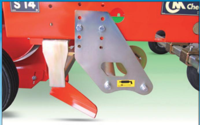
Supporto altezza rulli, le piastre di attacco a più fori permettono di regolare la distanza dei rulli da terra al variare dell'altezza dell'aiuola
